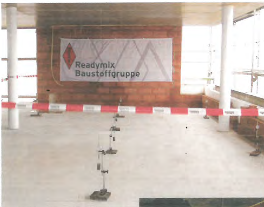
Abb. 3: Messeinrichtungen in den Feld- und Gurtstreifen
